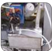
Резервуар для масла с возможностью наполнения снаружи и индикатором уровня масла
